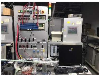
製作した燃料電池がどのぐらいの性能を持っているのかを計測することができます。燃料電池評価システムは学生 1 人 1 人に用意されていて、自らテストプログラムを作成します。テストプログラムを作成するときは基準が設けられており、他の燃料電池とも比較ができるようにしています。そのほかにも燃料電池の特性によって耐久テストを行ったりします。
