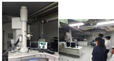
この顕微鏡は、触媒などの材料を原子レベルで観察、分析、記録することができます。特徴は、材料を観察しながら触媒の環境を直接変化させることができることです。触媒に水素を与え続けたときにどのように変化するかなどを観察することができます。世界に数台しかない観察システムとのこと。
