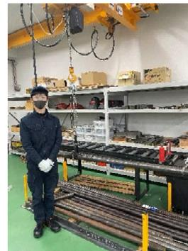
製作する上で様々な機械を使用したため自分自身の**技術レベル向上**にもつながった。吊るしのテストでは学校にある棒材(**S45C**)を使用して行った。S45Cの比重は**7.85g/cm<sup>3</sup>**材料は**φ60×3000を2本で重量**にして**約133kg**を**問題なく、上げ下げ**することができた。
