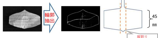
縦割りの結晶は、輪切りのウェハの結晶とは異なる結晶方位のため、測定条件が異なる
