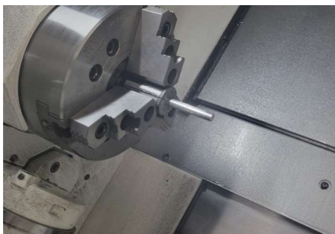
図3 アルミ材をチャッキングした様子
