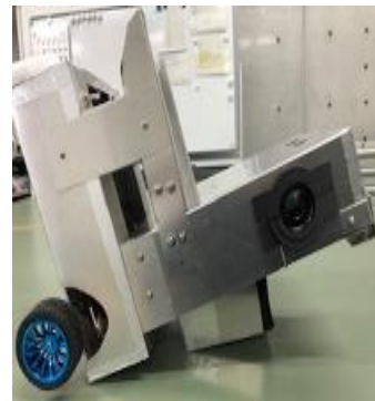
図 3: 重心が後ろで倒れてしまう
