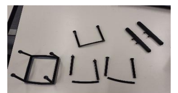
脚の破損と再設計
